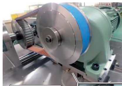
モータ移動時タイミングベルトのテンション保持
